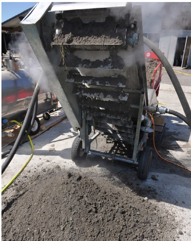
Abbildung 6: Mit dem Dämpfförderband kann der Aushub von kleinen Flächen direkt vor Ort gedämpft werden (Foto: R. Total, Agroscope).
