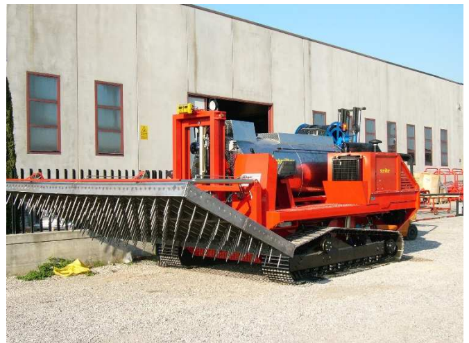
Abbildung 5: Für grosse Flächen gibt es Dämpfautomaten von der Firma Möschle Seifert Dämpftechnik (Foto: Möschle Seifert).
