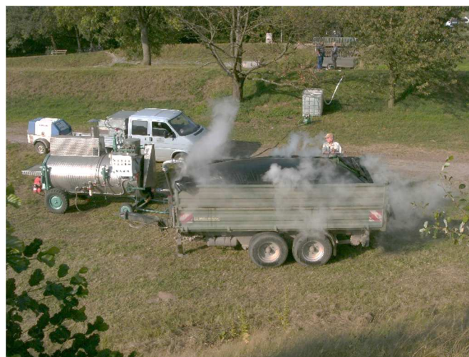
Abbildung 7: Für grössere Mengen Aushub, kann ein Anhänger mit einer Dämpfgabel bestückt werden. (Foto: Möschle Seifert).
