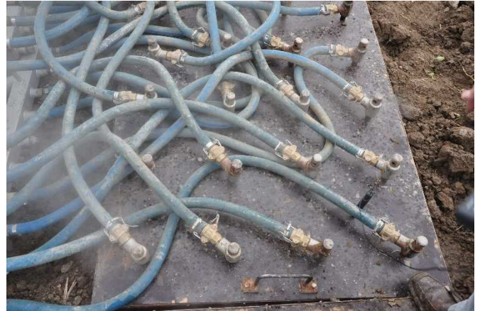
Abbildung 4: Mit der Injektortechnik kann bis 25-35 cm Tiefe Boden gedämpft werden. (Foto: R. Total, Agroscope).
